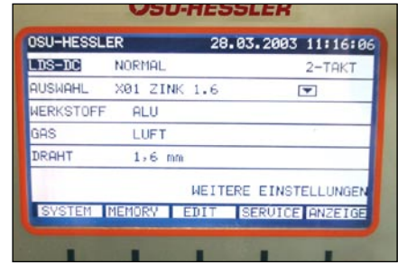
Ein grosses übersichtliches LCD-Display zeigt alle erforderlichen Spritzparameter und Einstellungen
