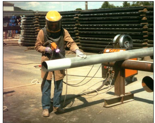
Spritzverzinken von Rohren mit dem bewährten LD/U-2 Handspritzapparat
